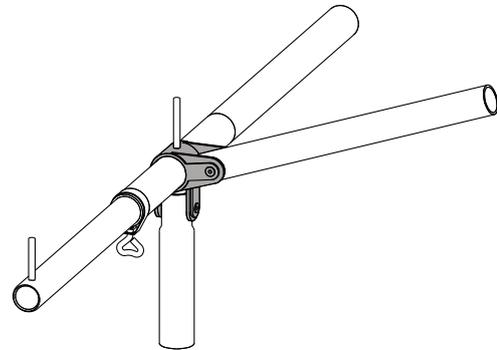
Verwendung von Präzisionsstahlrohr ausschließlich nach DIN EN 10305-3.
